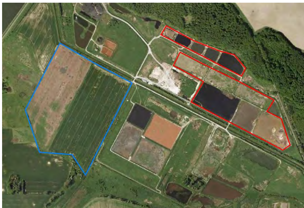
Figur 5.8 Arealer anvendt i ”farmingforsøg” 2003-2013 /28/. Bassinerne, som jorden opgraves fra, er markeret med rødt, mens arealet, som jorden udsprede på, er markeret med blå.
